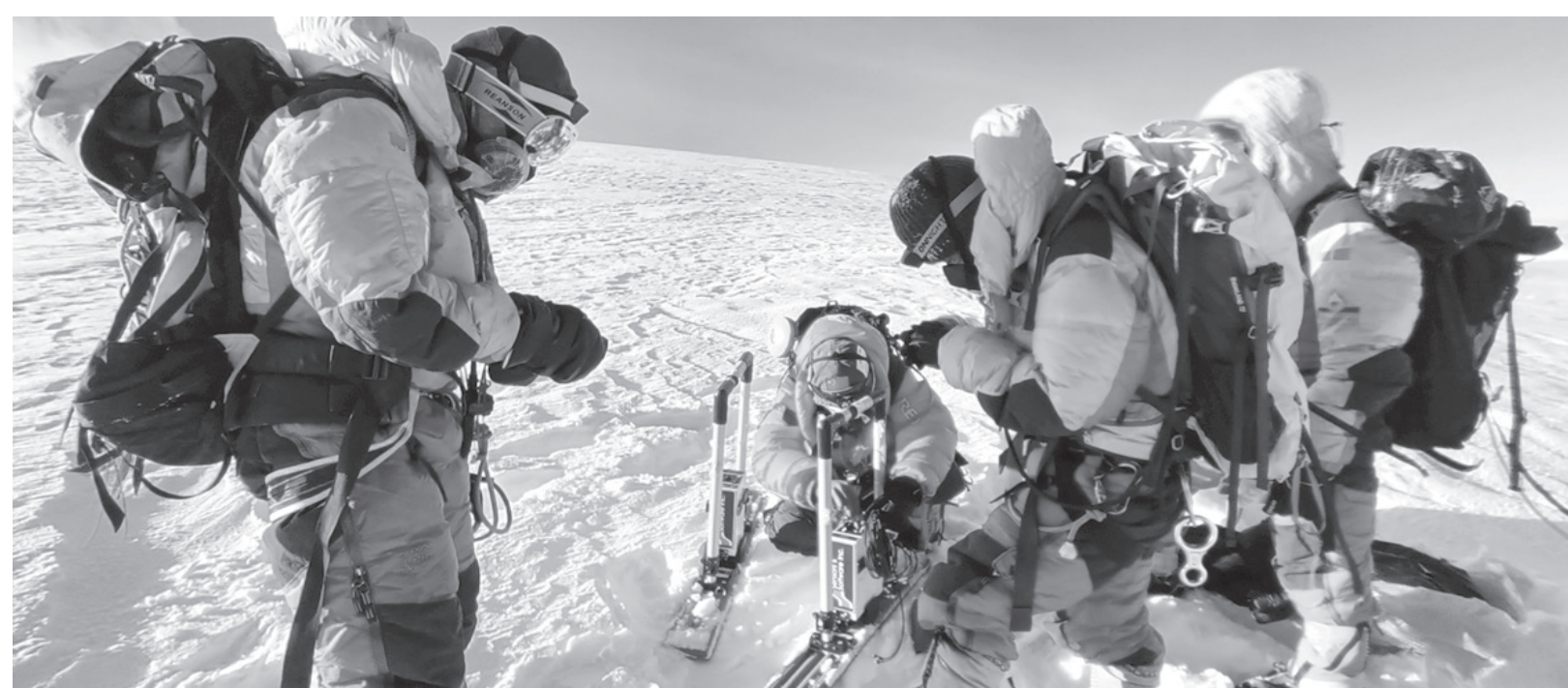
圖為科考隊員用雷達測厚儀，在海拔8201米的卓奧友峰峰頂測量冰雪厚度。
