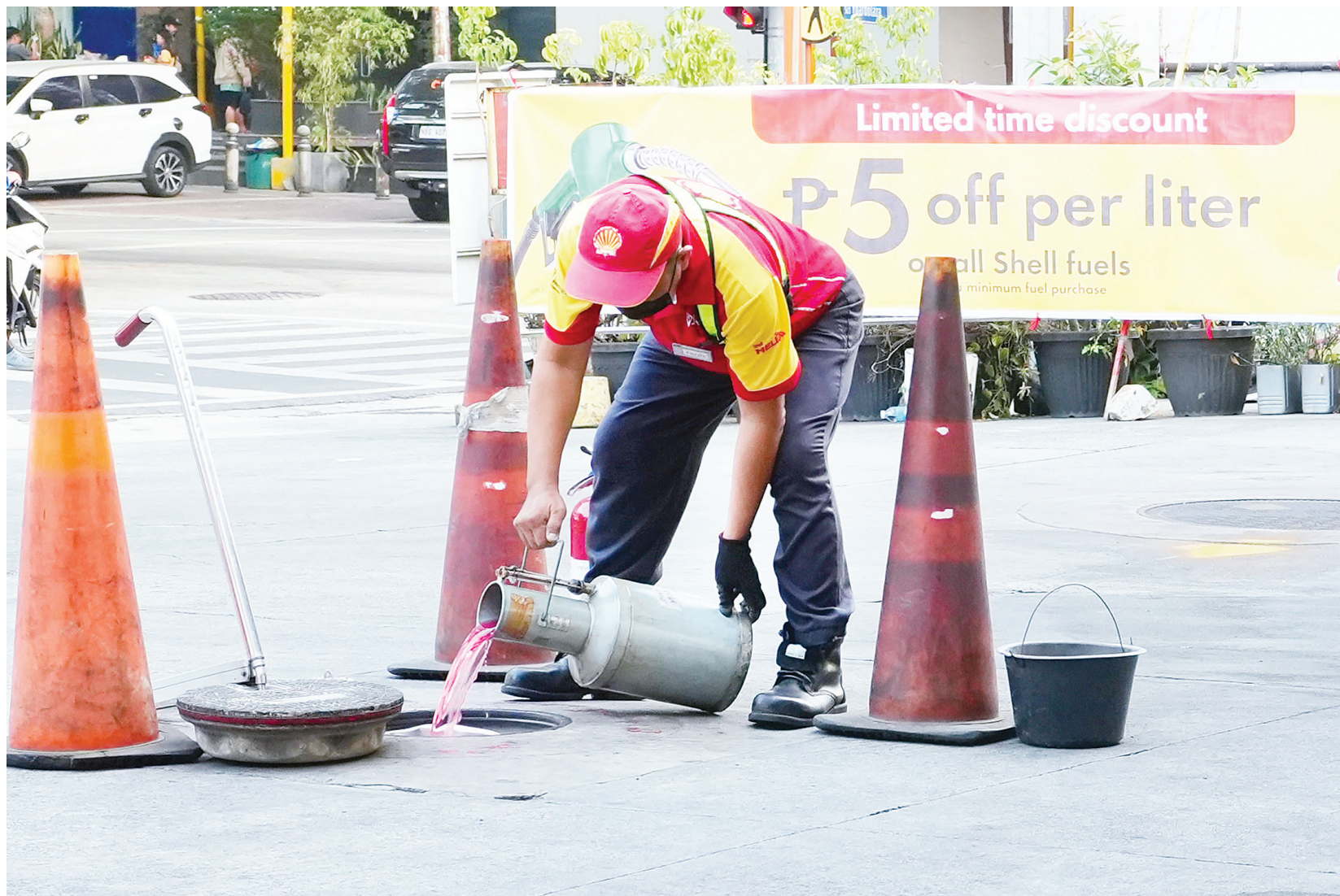
4月25日，計順市一個加油站的工作人員正在進行油泵校準，以比較實際輸出油量與加油機顯示量的差異。能源部於4月20日表示，該國的汽油供應至少還能維持54天，柴油50天，煤油129天，噴氣燃料60天，燃料油78天，液化石油氣40天。
