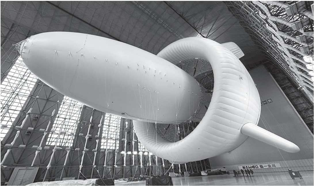
▲近日，在湖南岳陽一飛艇庫內的全球首台兆瓦級 S2000 浮空風力發電系統。 中新社
