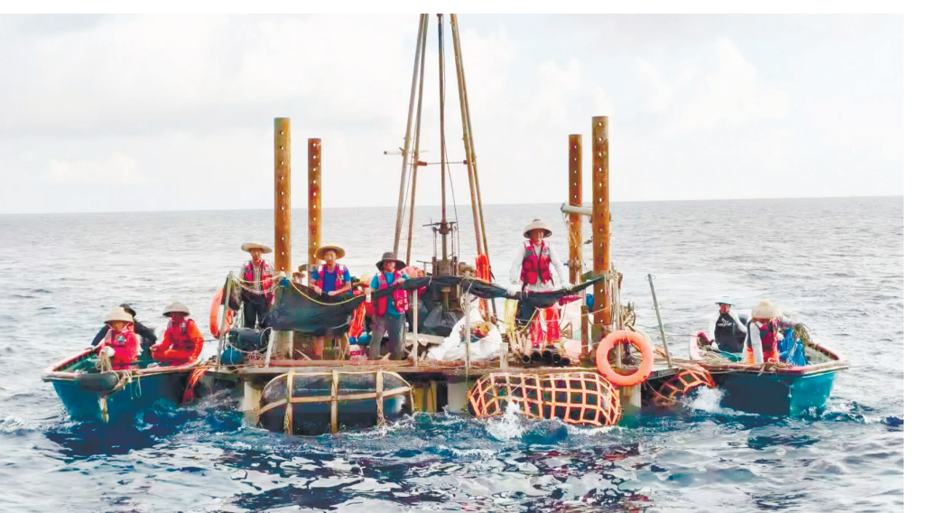
中國科學院南海海洋研究所在黃岩島海域搭建的漂浮式的原位採樣與實驗平台。
